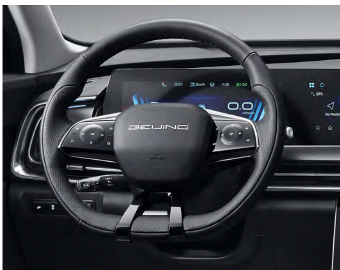
Kierownica wielofunkcyjna z panelami dotykowymi pokryta mikrofibrą
