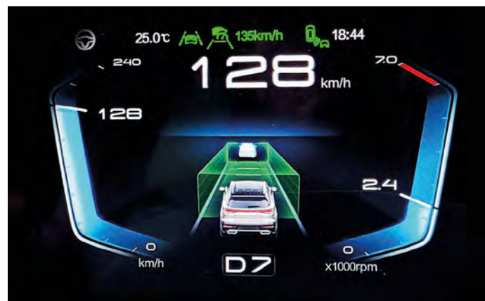
Inteligentny aktywny tempomat z funkcją regulacji odległości od poprzedzającego pojazdu
