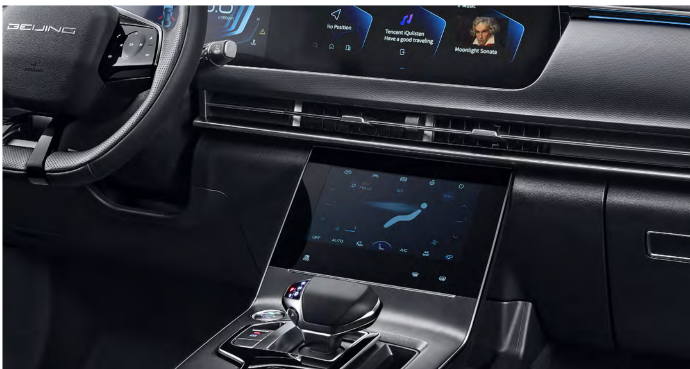
Dotykowy ekran o przekątnej 7-cali do sterowania klimatyzacją
