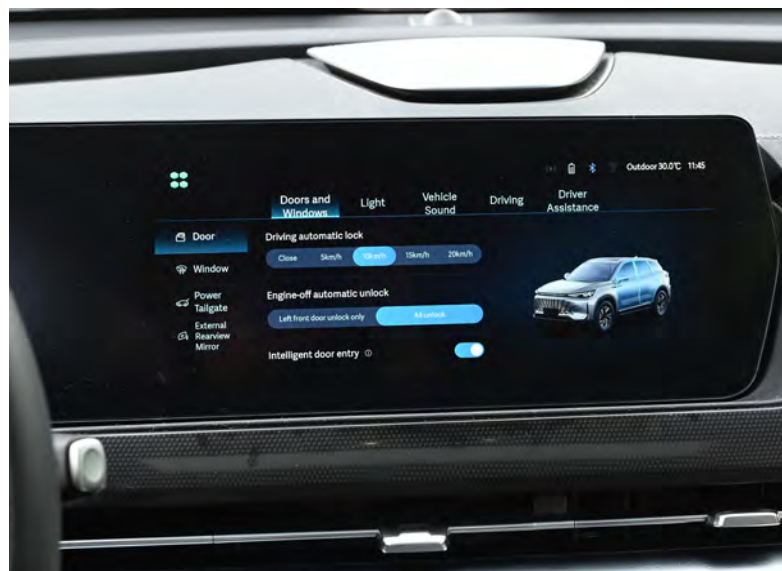
Dotykowy ekran multimedialny na środkowej konsoli o przekątnej 12,3-cala
