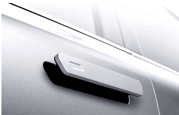
Chowane klamki w powierzchni drzwi
